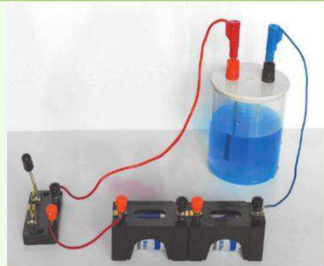
Hình 22.5. Mạch điện trong thí nghiệm tìm hiểu tác dụng hoá học của dòng điện
