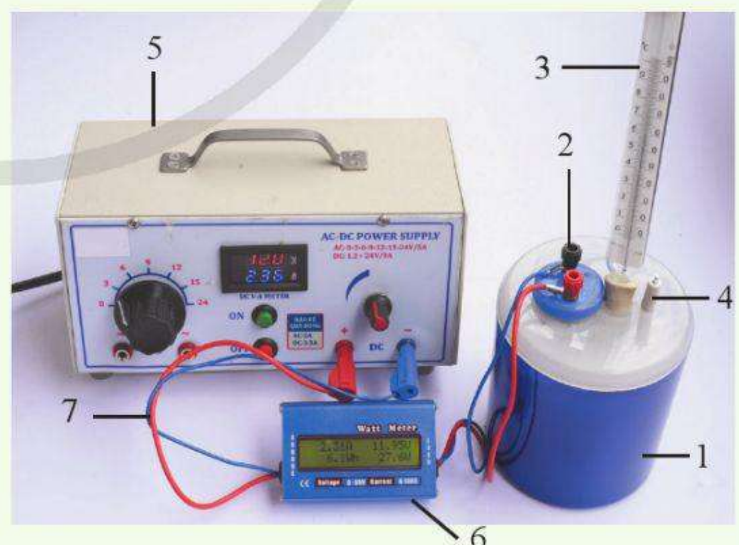
Hình 24.2. Đo năng lượng nhiệt bằng oát kế
