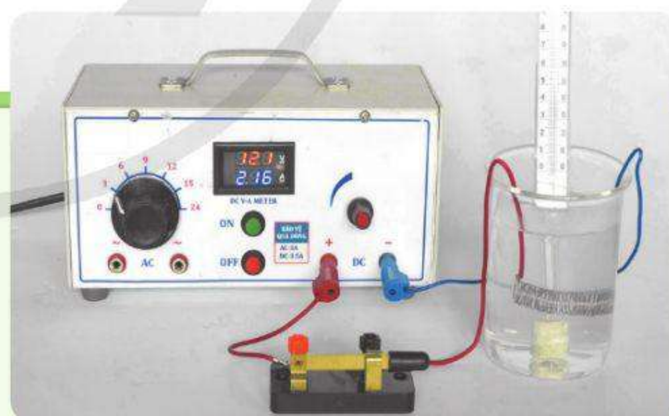
Hình 22.4. Bố trí dụng cụ thí nghiệm tìm hiểu tác dụng nhiệt của dòng điện
