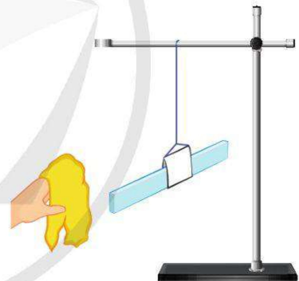
Hình 20.2. Đưa mảnh vải đã nhiễm điện lại gần thanh nhựa treo trên giá
